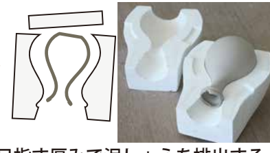
目指す厚みで泥しょうを排出すると 石膏に吸着した部分だけが残る
