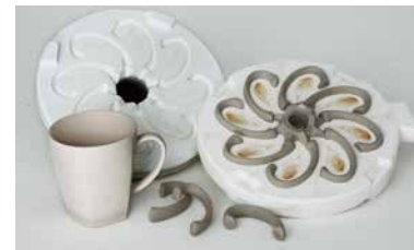
石膏が水分を吸収して固まる
